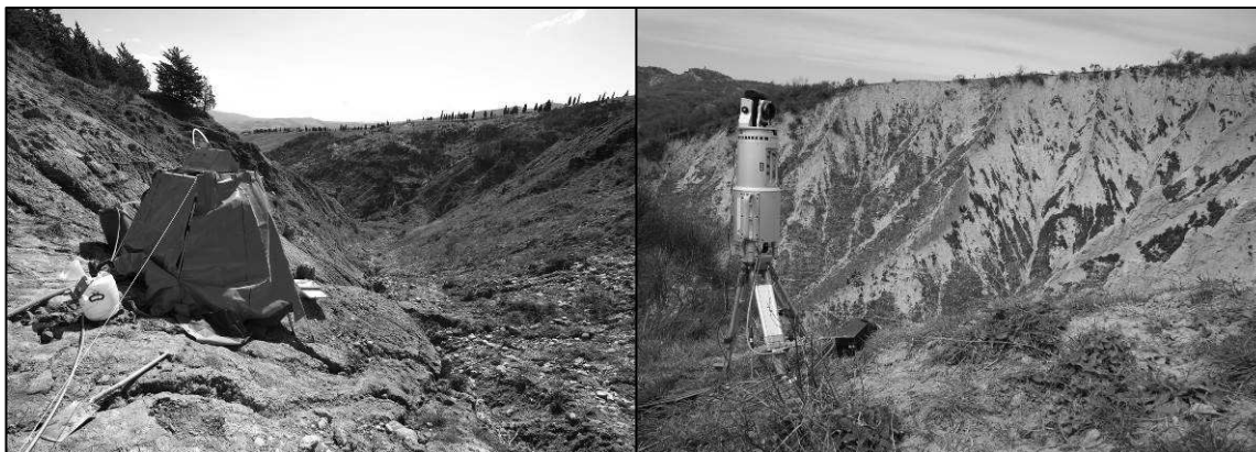
Obr. 1 Dešťový simulátor v zájmovém území Radicofani (vlevo), laserový scanner v zájmovém území Bagnoregio (vpravo)
