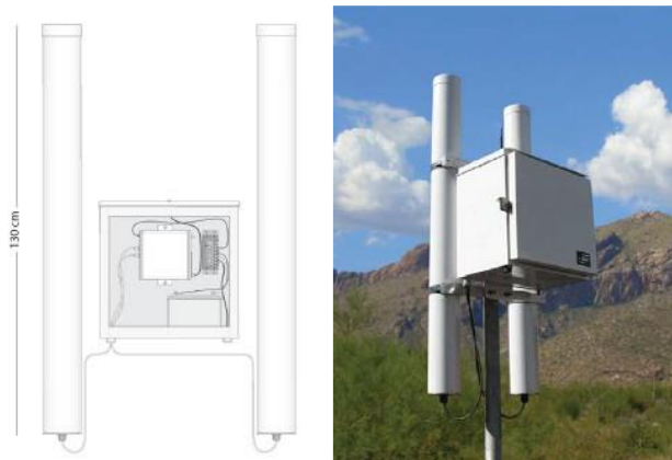
Obr. 1 Sonda COSMOS CRS1000/B (zdroj: Hydroinnova, Albuquerque, NM, USA)
