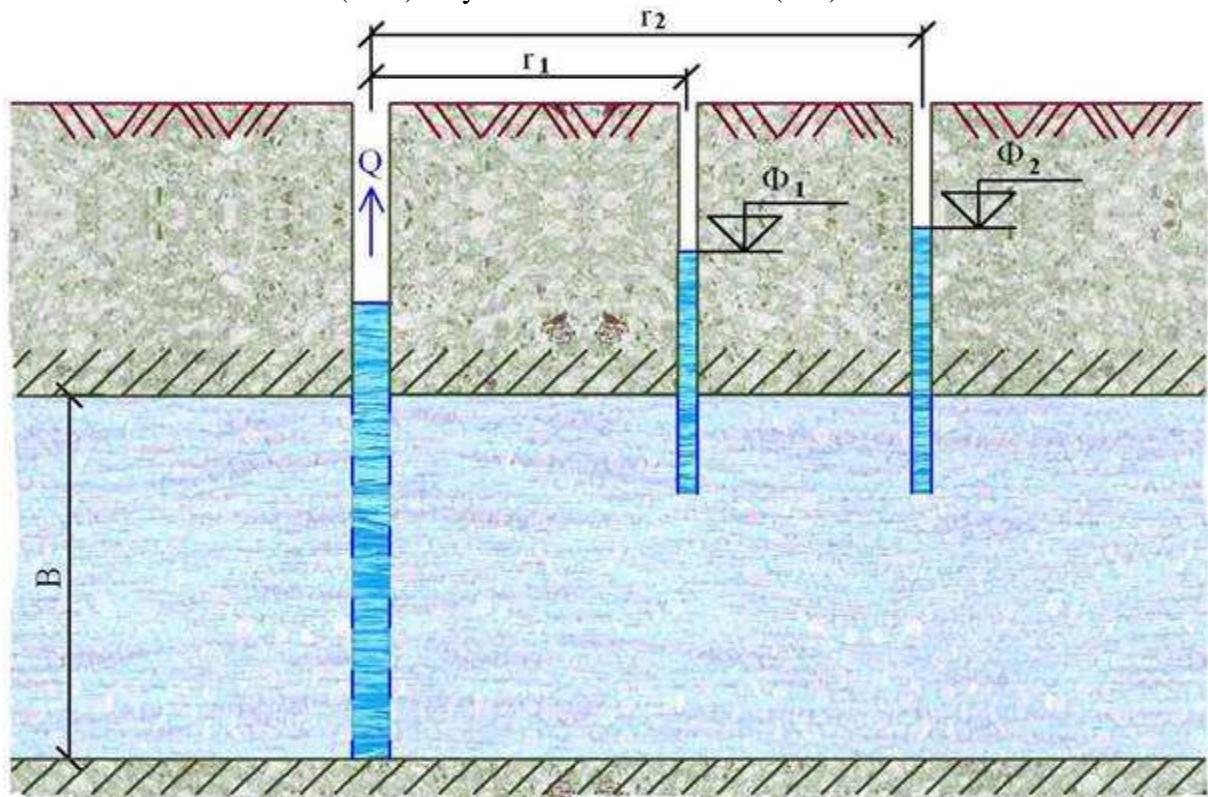
**B/** V homogenním izotropním kolektoru s volnou hladinou je vybudovaná úplná studna, ze které se čerpá konstantní množství vody  $Q$  ( $\text{m}^3/\text{hod}$ ). Báze kolektoru (nepropustné podloží) je na zadané výškové úrovni. Ve vzdálenostech  $r_1$  a  $r_2$  od středu studny se nacházejí dva pozorovací vrty, v nichž je hladina vody v úrovni  $h_1$  a  $h_2$  (m) (výšková úroveň hladin je měřena od stejné srovnávací roviny jako poloha nepropustného podloží).
