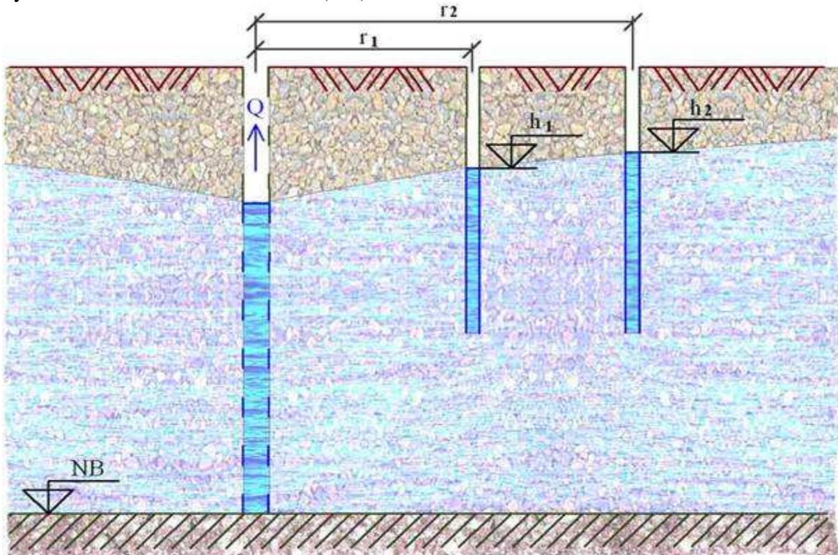
C/ V izotropním kolektoru tvořeném třemi vodorovnými vrstvami, ve kterém je volná hladina podzemní vody, je vybudovaná úplná studna, ze které se čerpá konstantní množství vody  $Q$ . Studna má poloměr  $r_0$  a voda v ní je v úrovni  $h_0$ . Ve vzdálenosti  $R$  od středu studny se nachází pozorovací vrt s hladinou vody na úrovni  $h_R$ . Výšková úroveň nepropustné báze a výškové rozhraní jednotlivých vrstev  $z_1$  a  $z_2$  jsou zadané.
