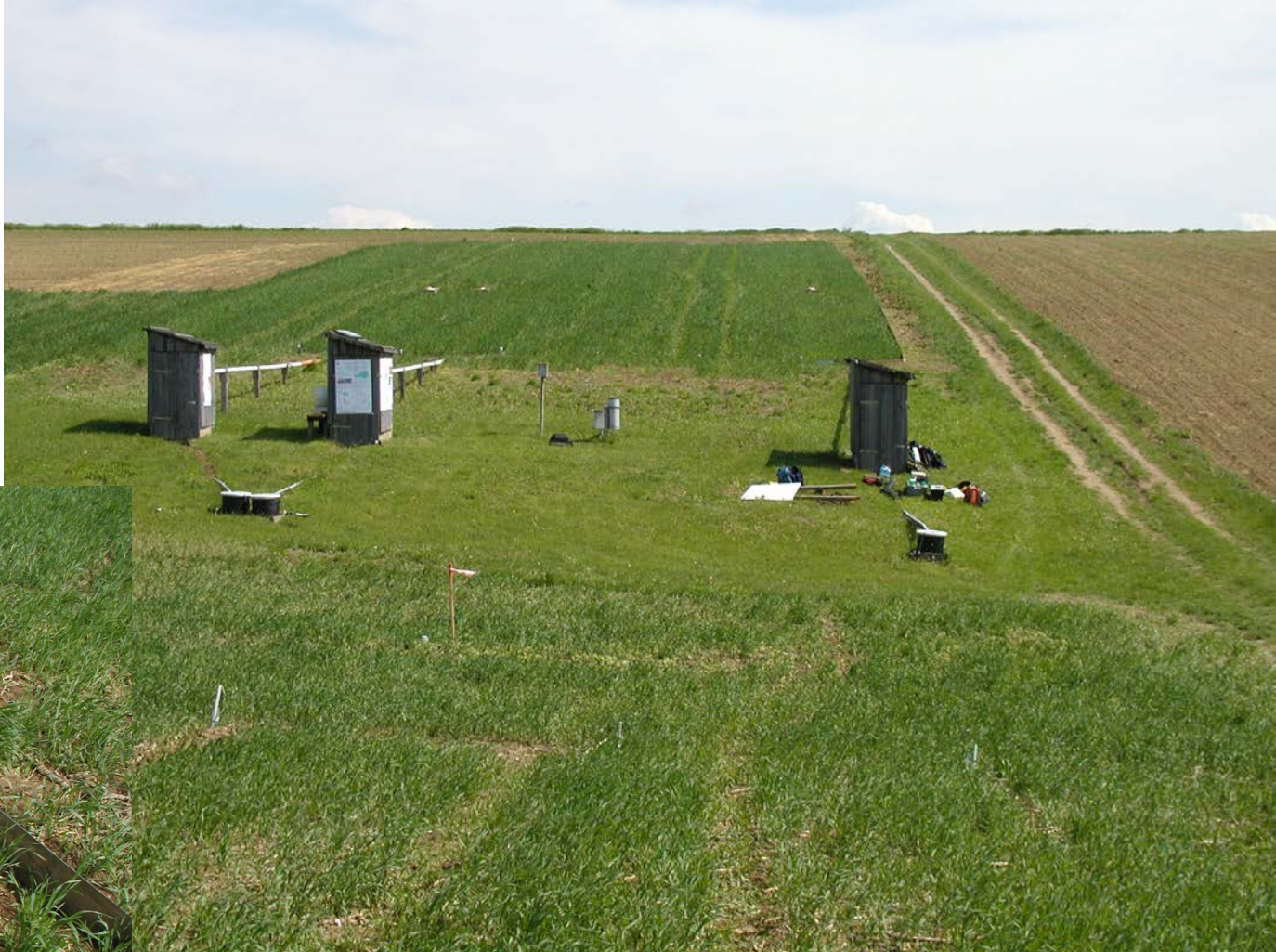
Experimentální plochy pro měření smyvu (vlevo plošného) (Mistelbach, Rakousko)
