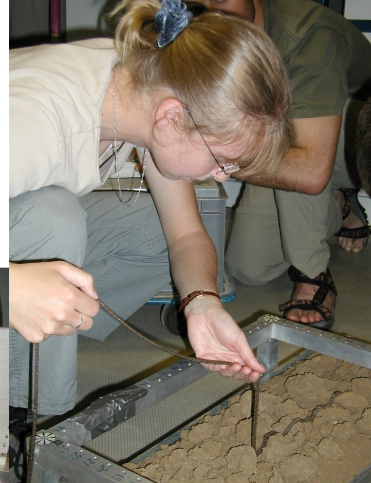
Měření drsnosti povrchu pomocí jehel a řetízku (BOKU Wien)
