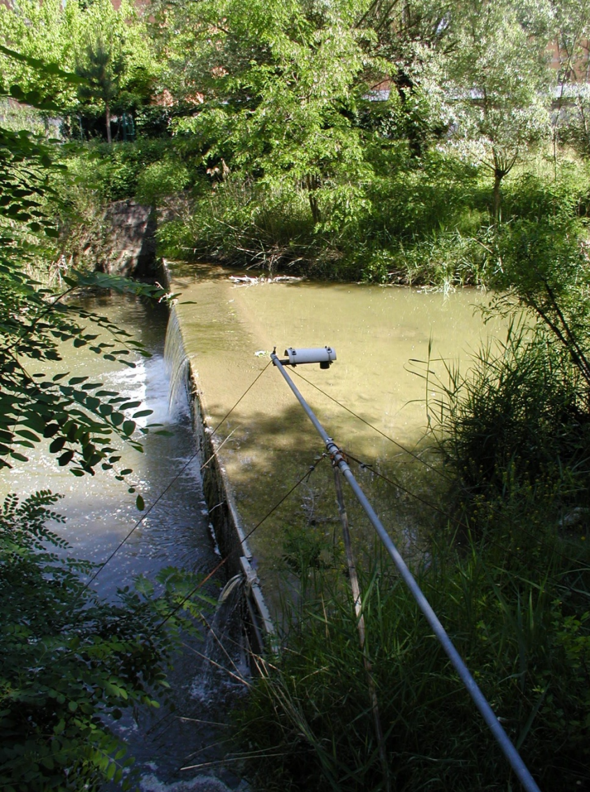
Vybavení měrného profilu ultrazvukovým čidlem pro měření hladiny a samplerem pro odběr vzorků (Florence, Itálie)
