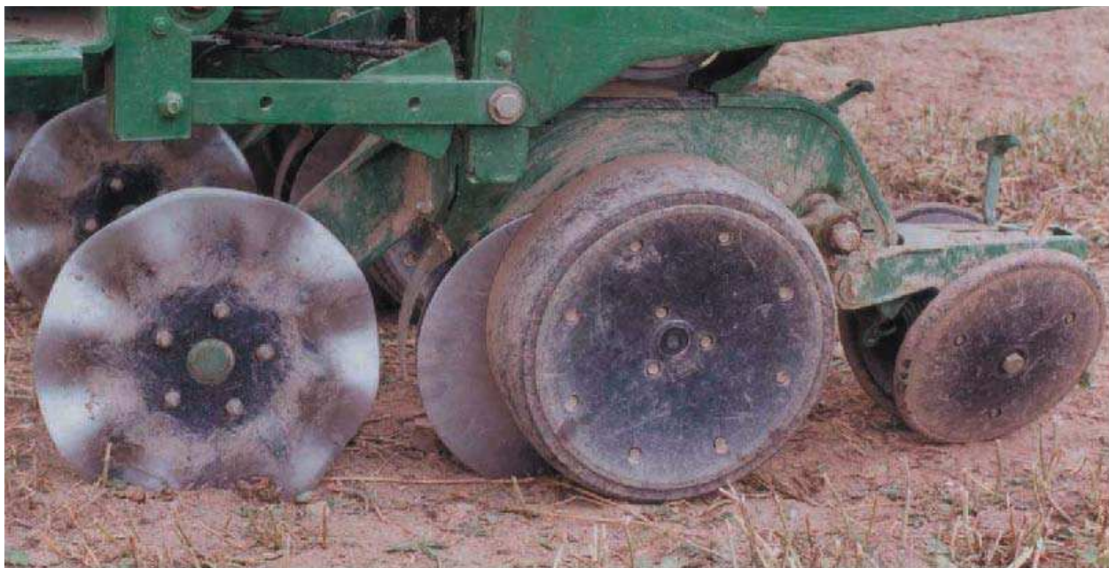
Obr. 6.4. Stroj na přesné setí kukuřice do mulče vybavený prořezávacími kotouči a dvoukotoučovými secími botkami s omezovači hloubky setí
