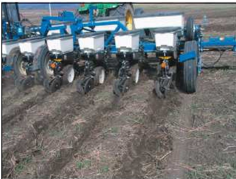
Obr. 6.3. Setí širokořádkové plodiny bez jarní předsetové přípravy půdy – jízdy ve směru vrstevnic přispívají k ochraně půdy před vodní erozí
