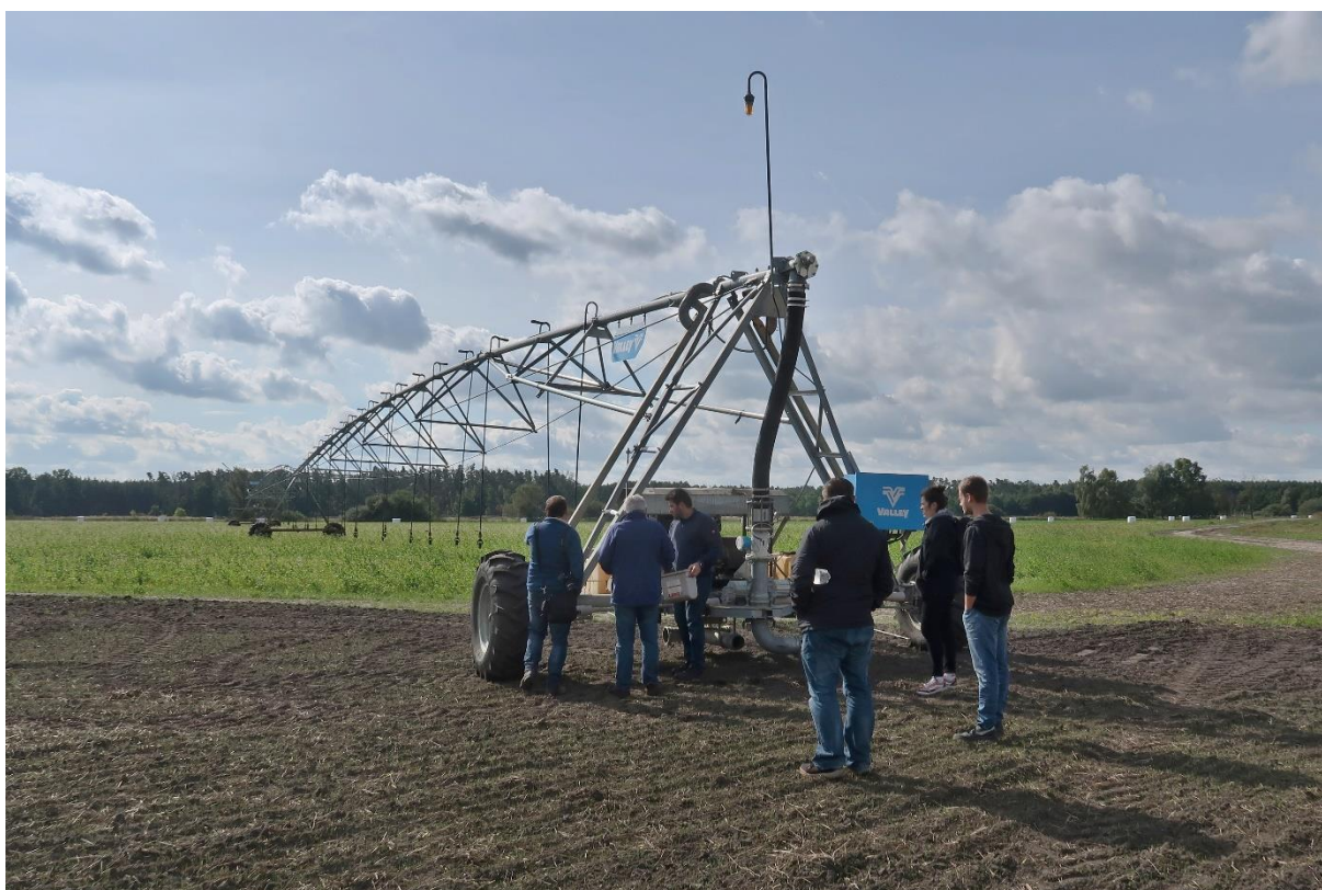
Obr. 10. Lineární zavlažovací stroj. Podobný princip, ale s přímočarým pohybem.
