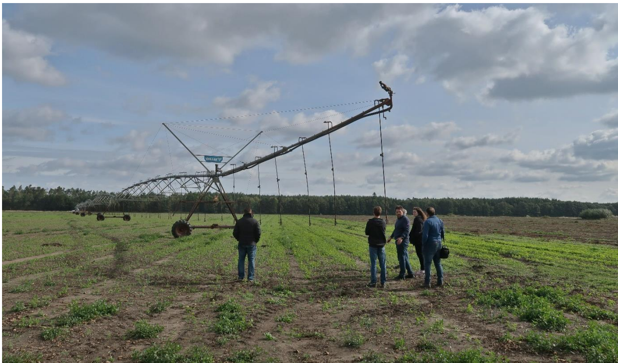
Obr. 8. Pivotový zavlažovací stroj, délky ramen se ohybují 300 – 900 m a montují se na místě.
