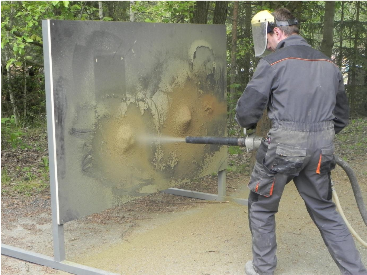
Obrázek 4 – Nástřik bentonitu novou tryskou (funkčním vzorkem) na zkušební stěnu
