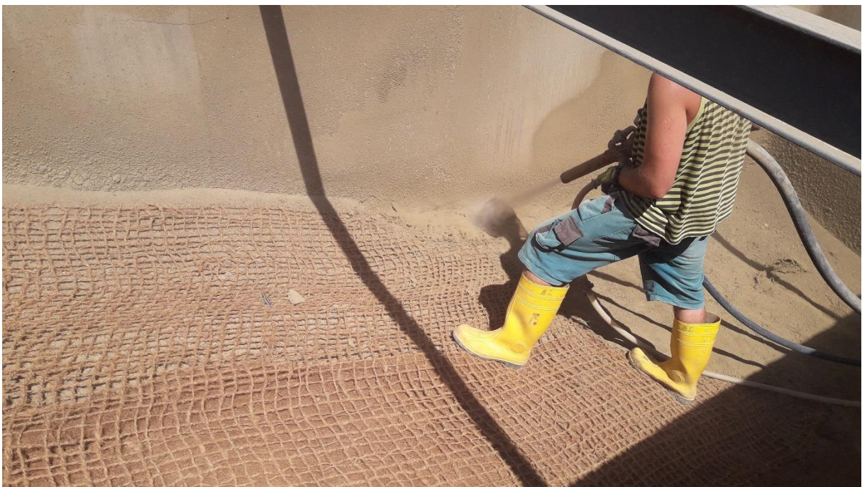
Obrázek 5 – Nástřik bentonitu novou tryskou (funkčním vzorkem) na návodní líc v sekčním modelu hráze
