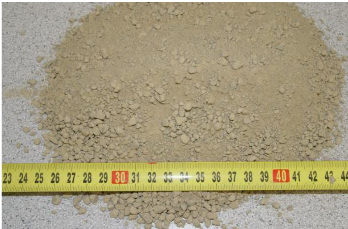
Obr. 2 výsledná směs pro bentonitovou těsnící vrstvu
