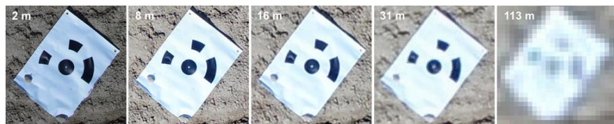
Obr. 14: Výřez vřícovacího bodu velikosti 35 cm z ortofotomapy generované ze snímků pořízených v různých letových hladinách
