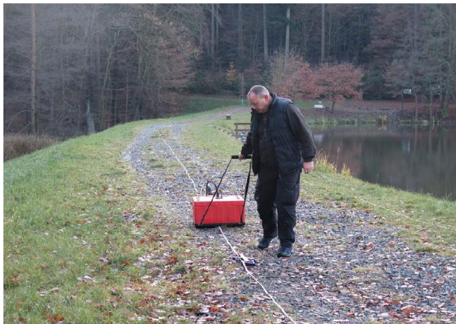
Obr. 3: Georadar - měření anténním systémem 200 MHz
