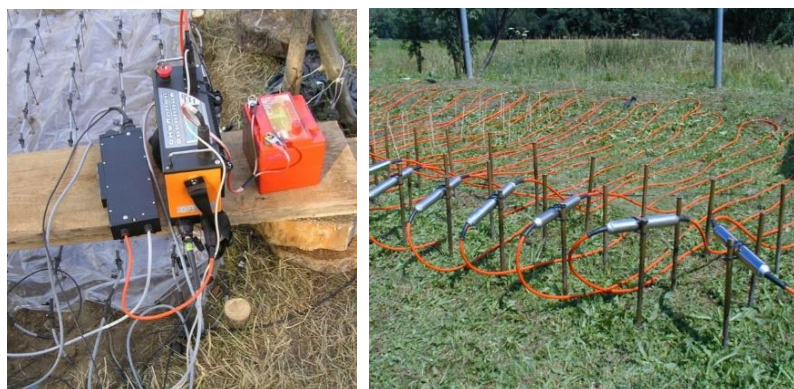
Obr. 2: Automatický geoelektrický systém ARES sestávající se z centrální řídicí jednotky, multiplexoru, pasivního multielektrodeového kabelu a 12 V baterie. Napravo aktivní (inteligentní) multielektrodeový kabel vhodný pro delší profily.
