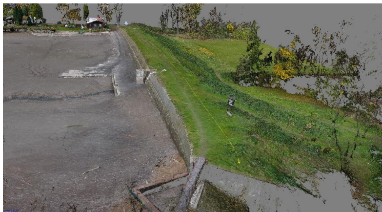
Obr. 18: Fotogrammetricky získaný 3D model hráze rybníka Podviňák (listopad)
