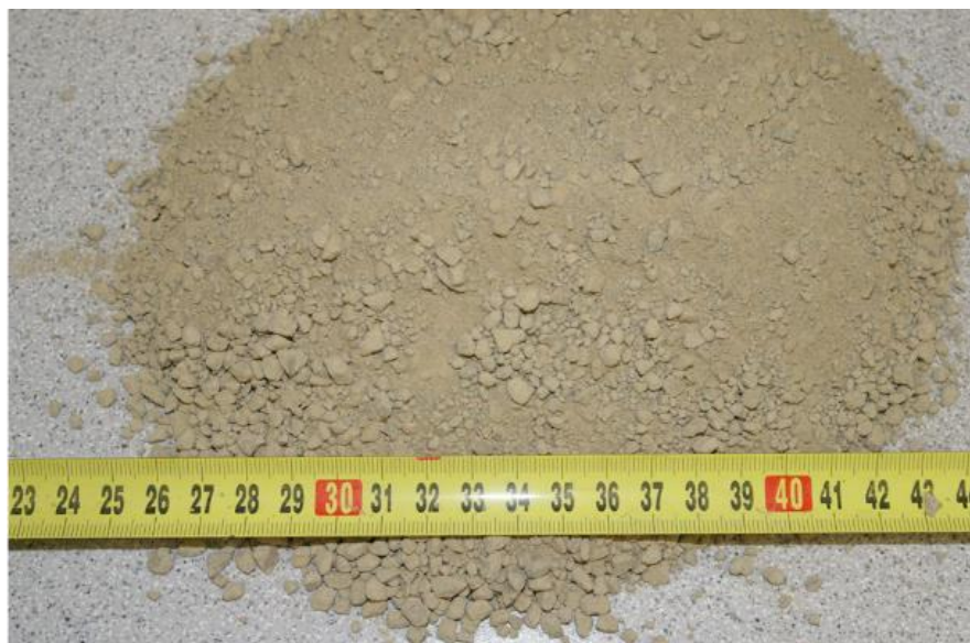
Obr. 1 Směs B75 REC MIX I, vyvinuta pro technologii stříkaného bentonitu
