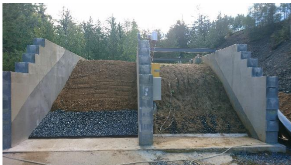
Obr. 8 Sekční modely hrází použité pro experimentální ověření účinnosti těsnění
