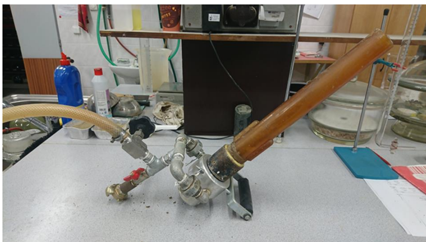
Obr. 5 Funkční vzorek „Tryska pro aplikaci jílových směsí pro potřeby sanace poruch historických rybníků“ v laboratořích Fakulty stavební
