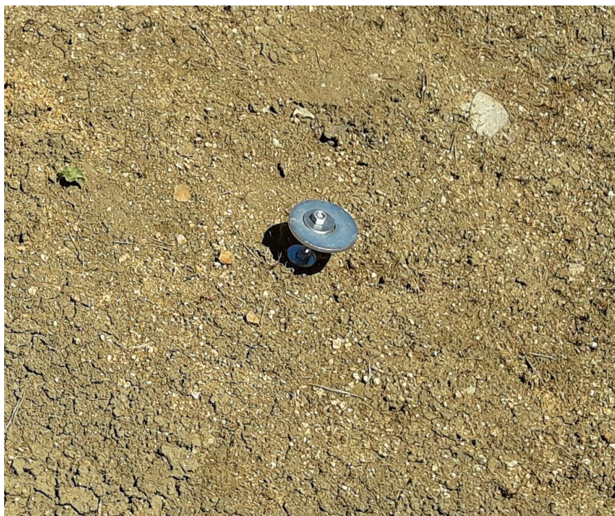
Obr. 6 Terčík umístěný v ploše, na niž má být aplikována těsnící vrstva
