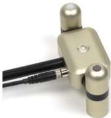
Obr. 6-15: Pyranometr APOGEE INSTRUMENTS, SN 500 použitý pro stanovení krátkovlnné solární radiace S_t
