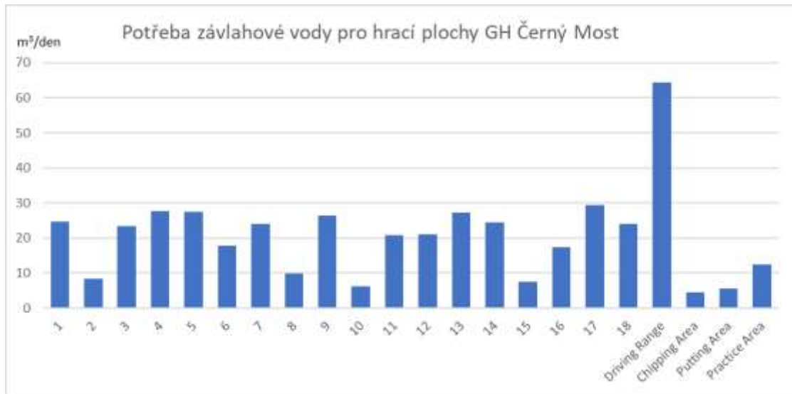
Obr. 3-28: Celkový denní objem závlahové vody v letních bezdeštných dnech (dle jednotlivých jamek)
