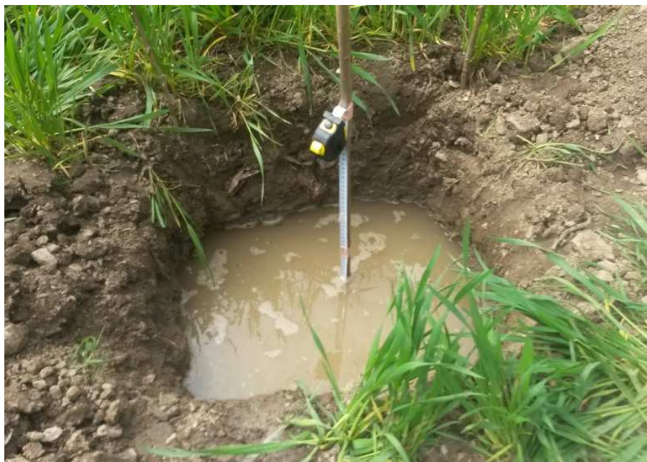
Obr. 2: Vsakovací test, sonda 1
