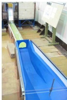
Obr. 9: Fotodokumentace fyzikálního modelu VD Ludkovice ve VH laboratoři: a) přeliv a spadiště, b) odpadní chodba a vývar
