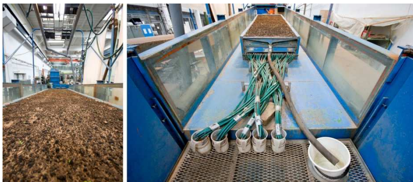
Obr. 1: Laboratorní dešťový simulátor KHMKI, ČVUT
