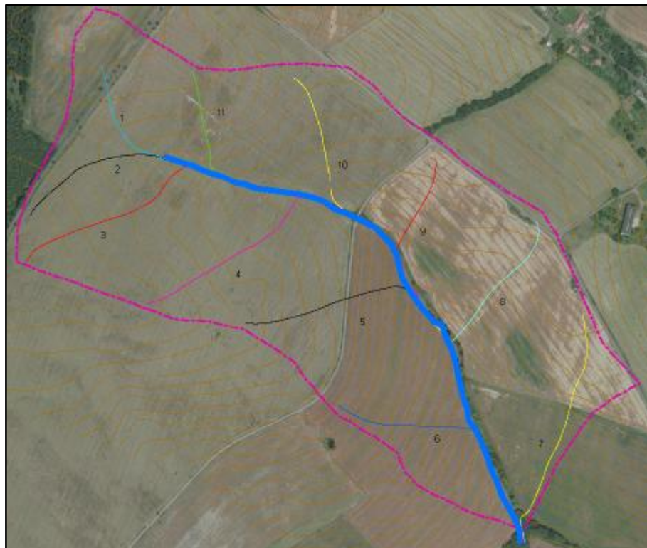
Obrázek 26: umístění jednotlivých profilů a dráha soustředění odtoku.
