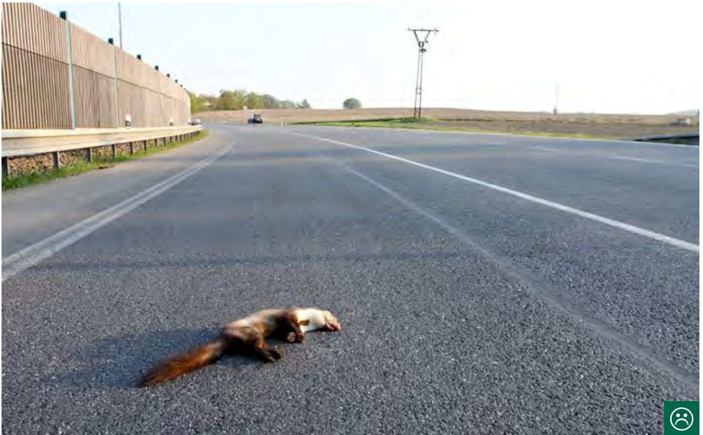
Obr. 10.54 Jednostranně umístěné protihlukové stěny představují zvýšené riziko mortality. Zvířata, která se pokoušejí přeběhnout silnici, se musejí vracet přes jízdní dráhu zpět (na obr. kuna skalní). (© Václav Hlaváč)
