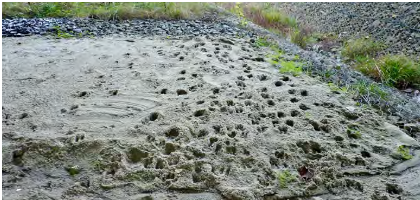
Obr. 12.17 K monitoringu účinnosti realizovaných opatření a ověření funkčnosti daného průchodu se využívá sčítání stop na pískovém loži. Příklad z podchodu pod zmodernizovanou železnicí v Dolní Lomné. (© Danuše Bartošová)
