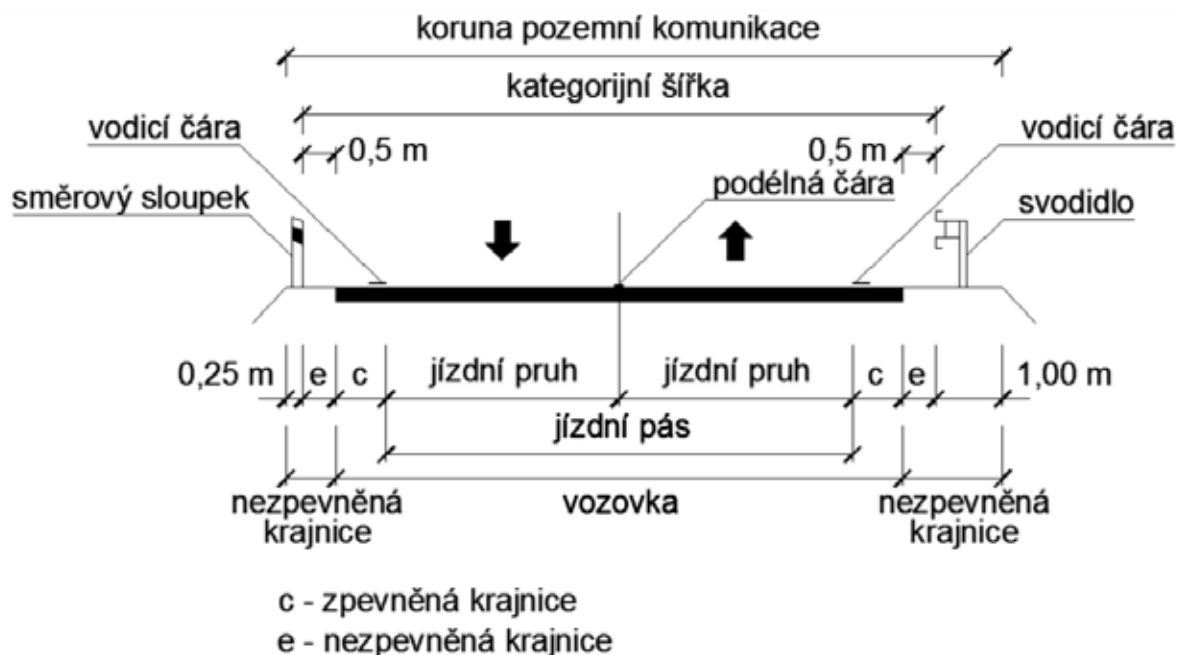
Obr. 5.2 Dvoupruhová, směrově nerozdělená komunikace – příčný řez. (© ČSN 73 6101)
