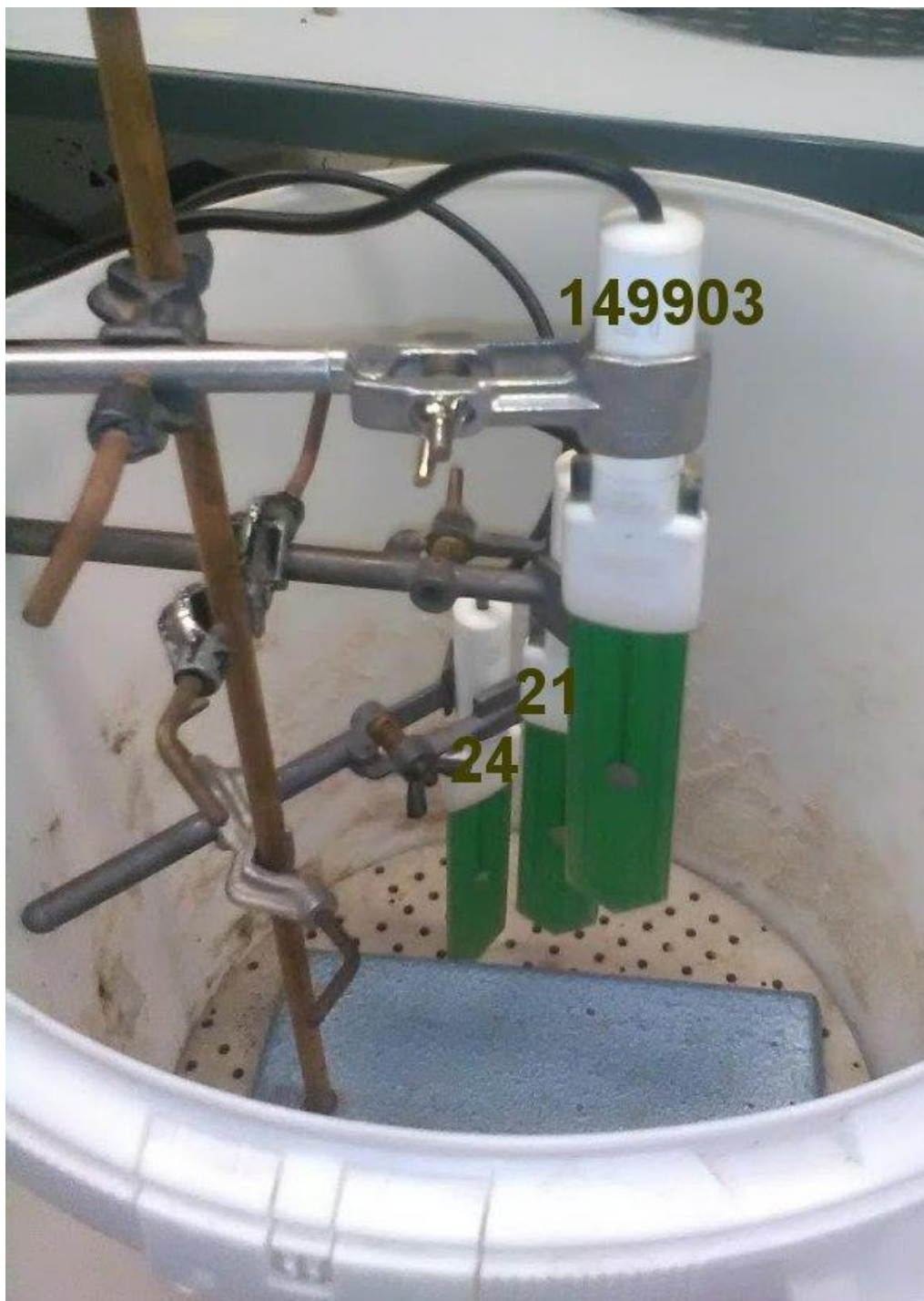
Obrázek 4: Rozvržení čidel v nádobě s pískem (před zasypáním pískem)
