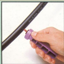
Natlačte zaostřený hrot do potrubí Xeritube
